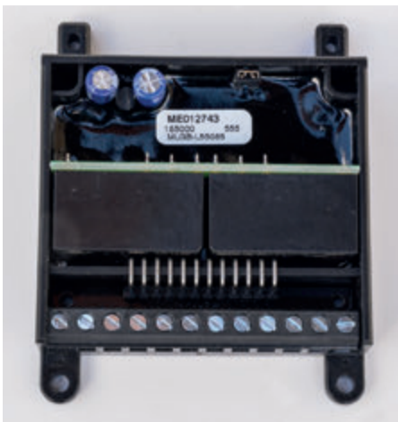
Innenleben des Kehrschleifenmoduls. Oben rechts befindet sich der Jumper.
