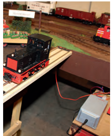
Statt eines Programmiergleises verwendet Holger Metschan einen Rollenprüfstand für die Konfigurierung.
