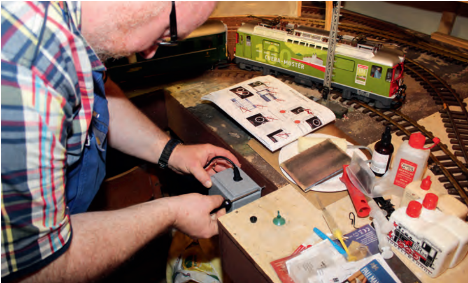
4 Der Booster versorgt den Teil der Anlage, auf dem die Rangier- und Abstellgleise zu finden sind. Er wird in der Mitte der Anlage montiert.
