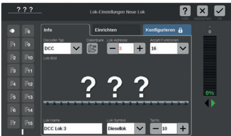
Neue Lokomotive: In den Lok-Einstellungen werden die wichtigsten Parameter der Lokomotiven eingestellt – besonders Decoder-Typ und Lok-Adresse müssen korrekt sein.
