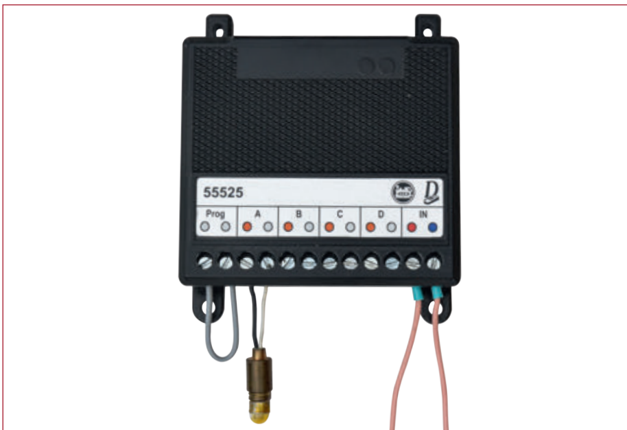
So wird programmiert: Die beiden linken Klemmen (Kennzeichnung Prog) werden überbrückt und am Ausgang A wird ein Verbraucher angeschlossen. Der Anschluss zur Zentrale erfolgt über die beiden rechten Klemmen (Kennzeichnung IN).
