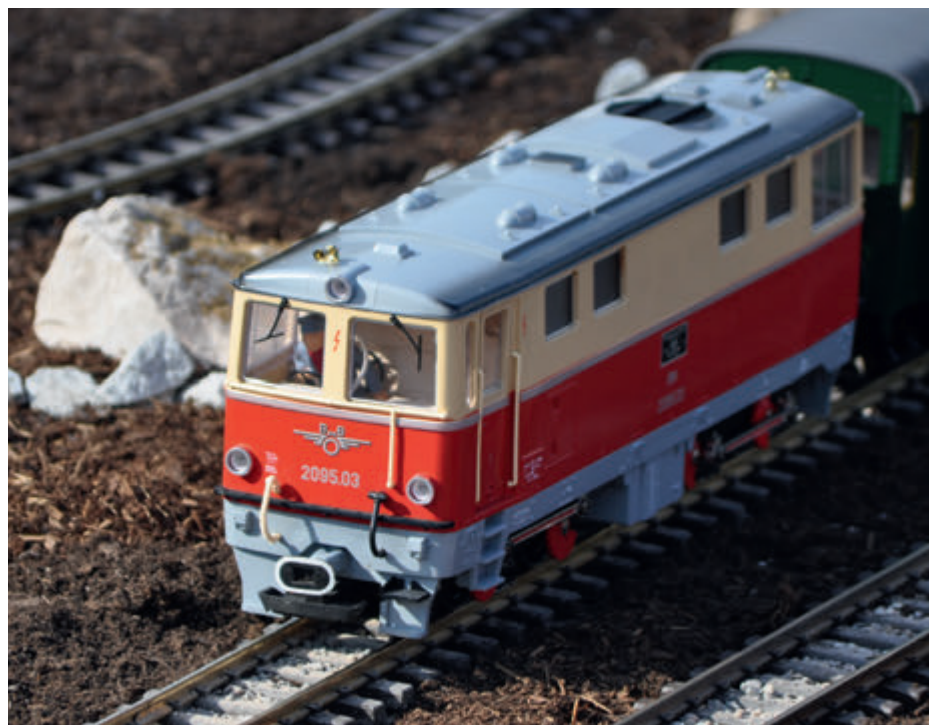
Großes Oval empfehlenswert: Bei der Einmessfahrt beschleunigt die Lok mehrfach auf die Höchstgeschwindigkeit – enge Radien, Weichen oder Steigungen sind zu meiden.
